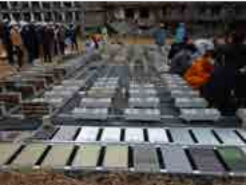
軍艦島での暴露試験の状況
