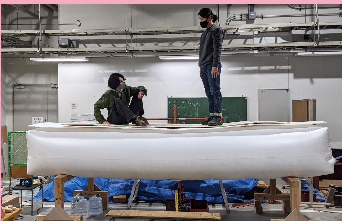
fig.06 床として利用可能な空気膜構造の開発に関する研究。実際に空気膜を作成して実験した
