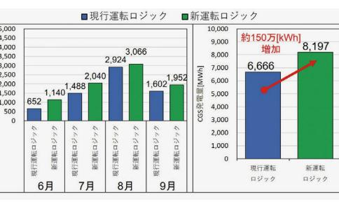
fig.07 新運転ロジックによるCGS発電量の分析結果
