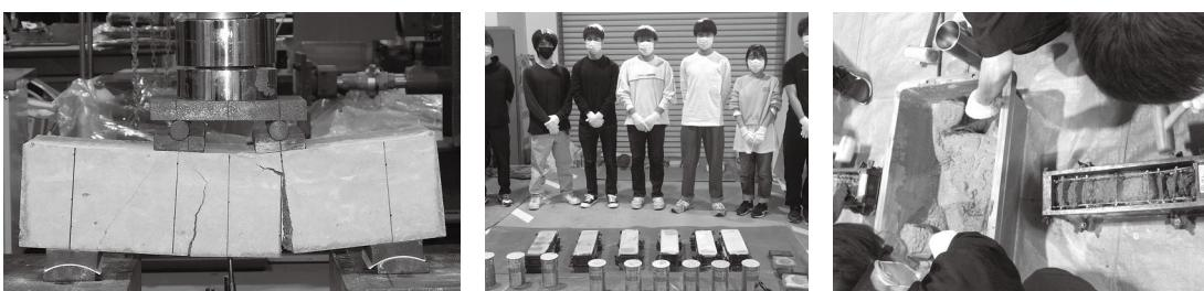
fig.01 右・中 | 試験体となる小型RC梁の鉄筋加工と配筋の作業 fig.02 右・下 | コンクリートを練り混ぜ試験体の型枠に打設する fig.03 中 | 2021年度のメンバーと作製した試験体 fig.04 右・上 | 小型RC梁に荷重を加え破壊するまでの様子を観察する fig.05 左 | 破壊したRC梁に曲げひび割れとせん断ひび割れが確認できる
