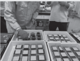
外装タイル試験体の製作状況
