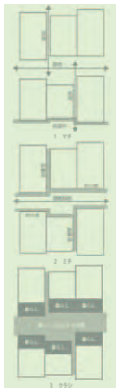
fig.01 上|模型写真。雁木の街並み fig.02 下左|平面詳細図。山側から日本海側へ強く吹く南風による災害拡大を想定し、東西方向の防火帯を計画した fig.03 下右|ダイヤグラム
