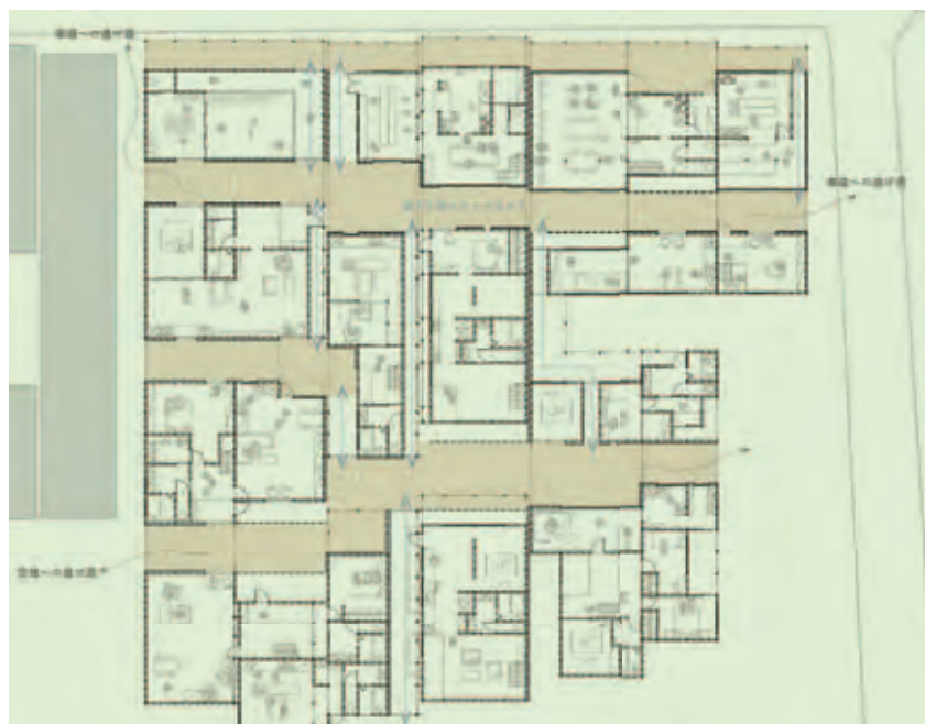
fig.04 右頁/上|全体平面図。対象敷地内の住民が集まり組合を結成し、その組合が事業主となって敷地内の木造住宅を組合所有の大規模木造建築として再編する。組合ごとに作ったファイバーがつながり、町全体へ広がっていく fig.05 右頁/中|矩計図。耐震性、耐火性を向上させ、災害に強い大規模木造建築へ再編する fig.06 右頁/下|模型写真
