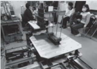
振動台を用いた小型模型の加振実験の様子で、周囲の学生が実験担当者
