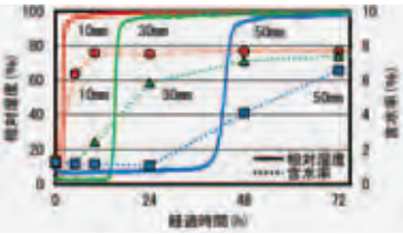
fig.05 水分移動特性試験結果(湿潤)
