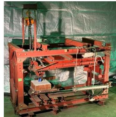
写真1 ひねり荷重試験機の外観
