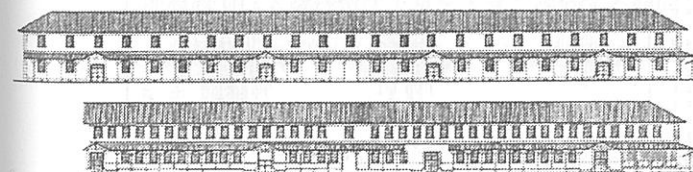
図 6. 白壁兵舎・立面比較 (上: 復原 下: 現状)
